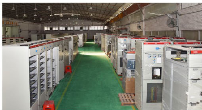
高低压柜生产车间
